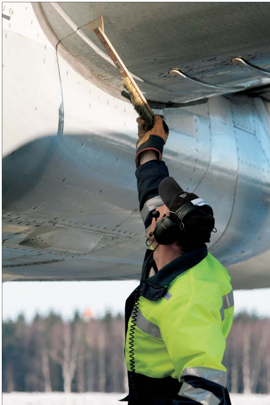
Jari Järvinen tekee ulkopuolista lähtötarkastusta ja tutkii onko siiven alapinnalle muodostunut jäätä.
