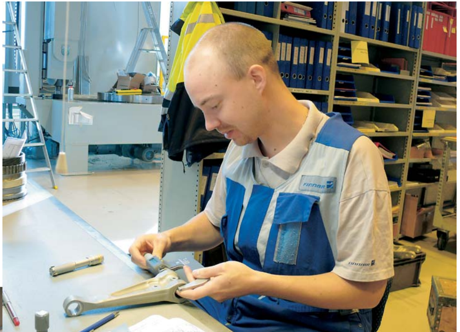
Laiteasentaja Kimmo Ravaska mittaa ATR72-nokkatelineen saksinivelen holkkipesän välyksiä.
