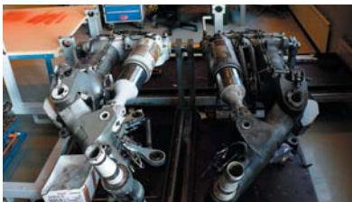
Kaksi peruskorjaukseen tulevaa ATR72-koneen päälaskutelinettä.
