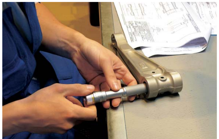
Saksinivelen ulkomitat mitataan mikrometrillä. Kimmo aloitti työt laskutelinekorjaamolla vuonna 2005.
