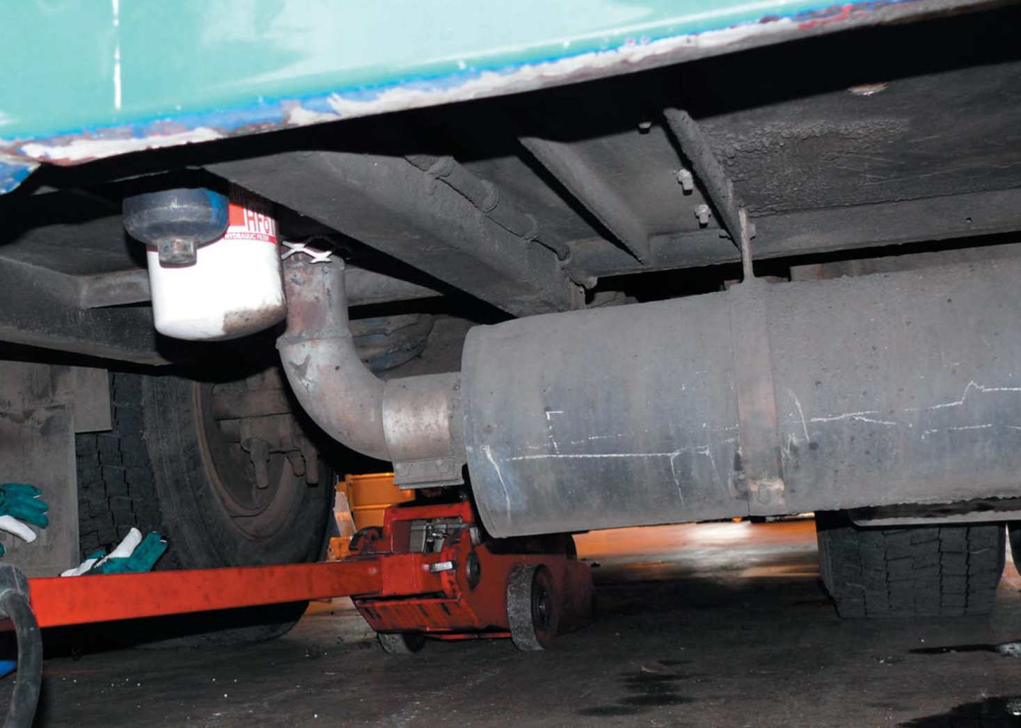
25 tonnin ajoneuvoa nostettaessa on tunkki asetettava tarkasti oikealle paikalleen.
