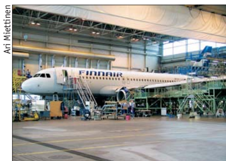
Kone pyrstötölkassa siipitelineet asennettuna.
