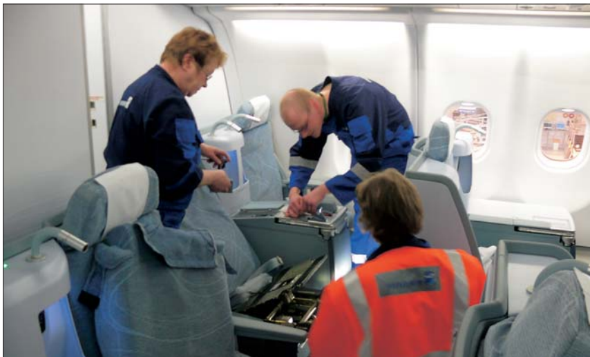
Tuolin säätö järjestelmässä on ongelmia, Sami Salonen, Timo Sievänen ja Erja Rautavuori korjaavat. Tässä business-luokan tuolissa on joka matkustajalla Airbagit.
