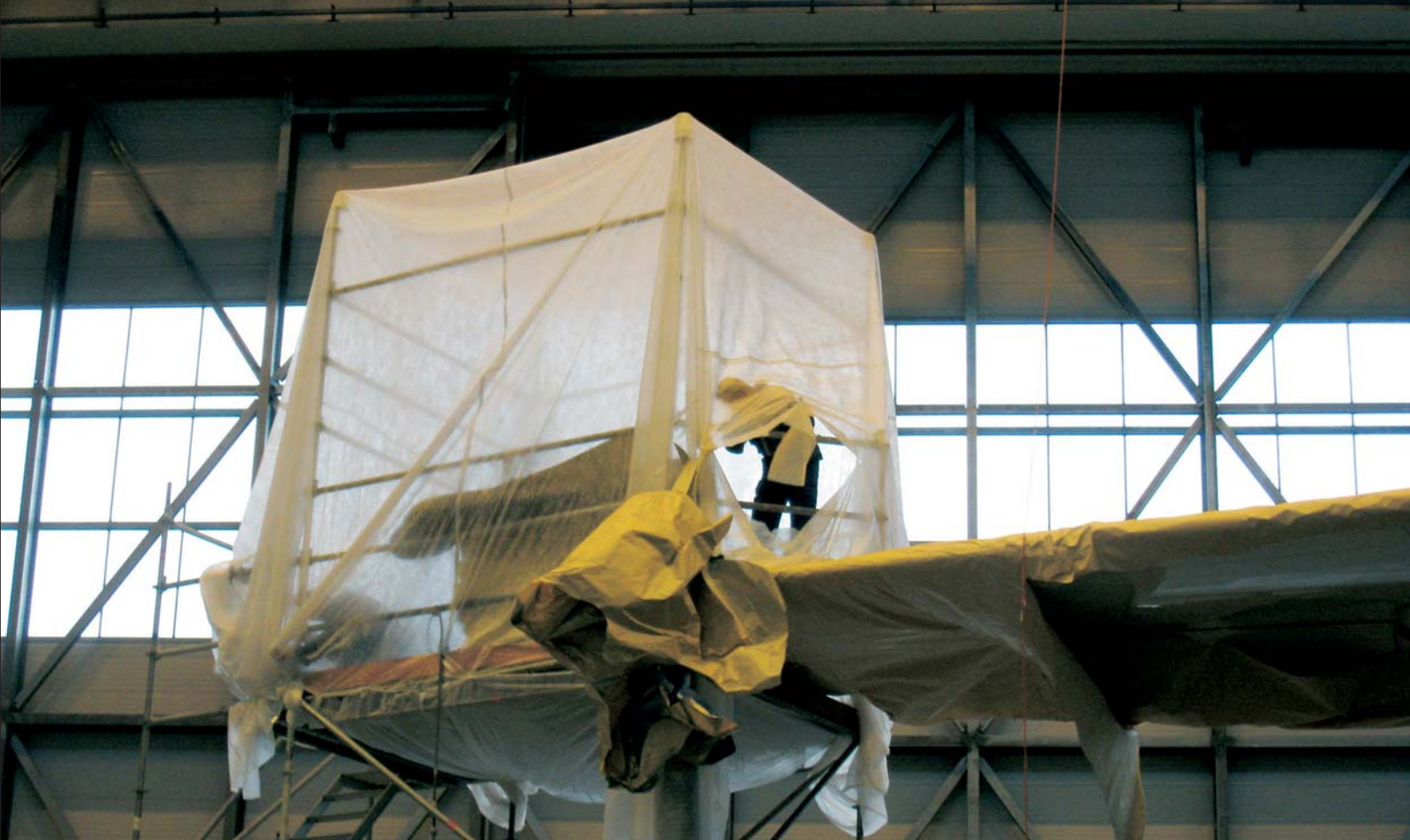
Siiven kärjen maalauksen ajaksi muu siipi suojataan maalausteltalla.
